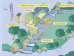
Principe de fonctionnement d'une centrale hydroélectrique
